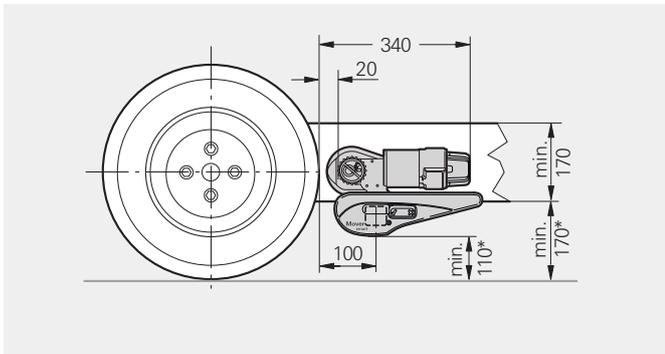
Das bewährte Befestigungssystem garantiert eine schnelle Montage der Mover. Es ist im Lieferumfang enthalten und ermöglicht einen Anbau der Mover an allen gängigen Standard L- und U-Profilrahmen.
