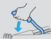
**DE** Feststellbremse lösen
