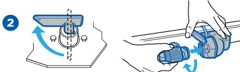
**DE Falls vorhanden: Batterietrennschalter einschalten; Stecker in Sicherungssteckdose einstecken**
